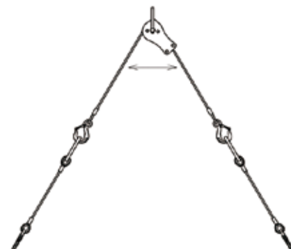
多点吊りセット使用
